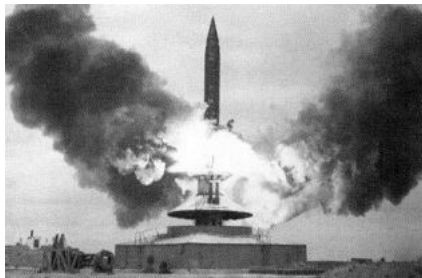
Отработка надводного старта баллистических ракет с подводной лодки на качающемся стенде СМ-49
