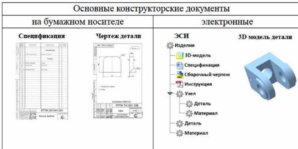
Рисунок 21 – Основные КД при бумажном проектировании и при применении ЭКД
