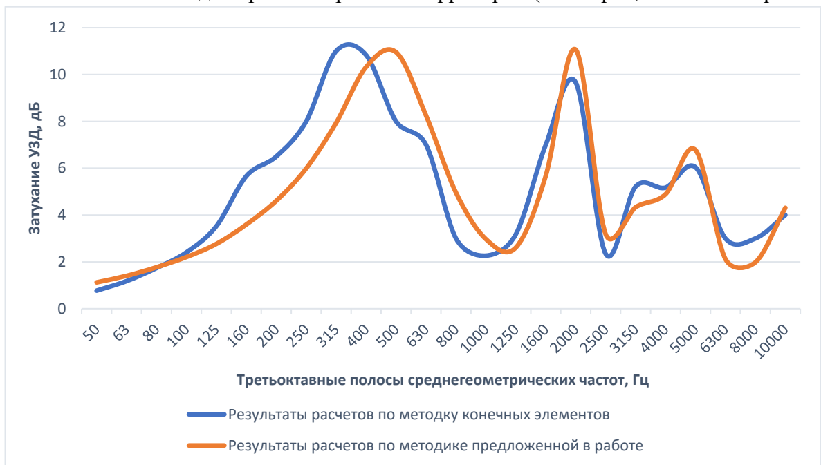
Рисунок 5.2– Сравнение результатов расчетов по предложенной методике и методике конечных элементов для примагистральной территории (15 метров, травяное покрытие)
