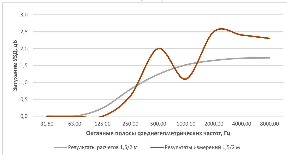
Рисунок 5.8– Сравнение результатов расчетов по предложенной методике и результатов измерений для примагистральной территории (30 метров, от 1,5 до 2,0 м, травяное покрытие)
