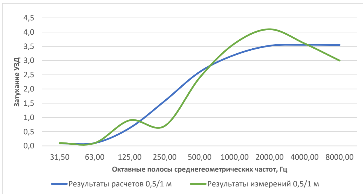
Рисунок 5.4– Сравнение результатов расчетов по предложенной методике и результатов измерений для примагистральной территории (15 метров, от 0,5 до 1,0 м, травяное покрытие)
