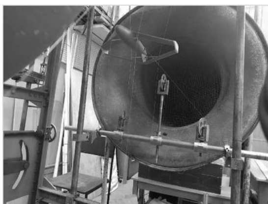
Рис. 1. Модель самолета в аэродинамической трубе
