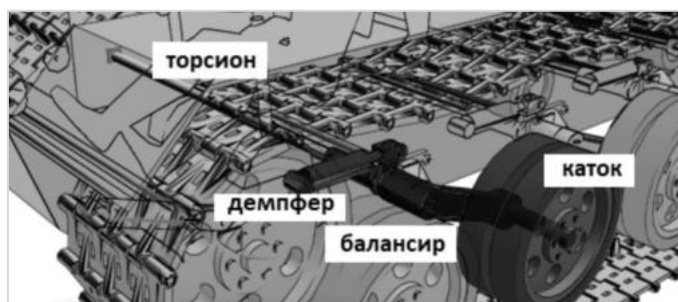
Рис. 1. Торсионная подвеска гусеничного транспортера корпуса
