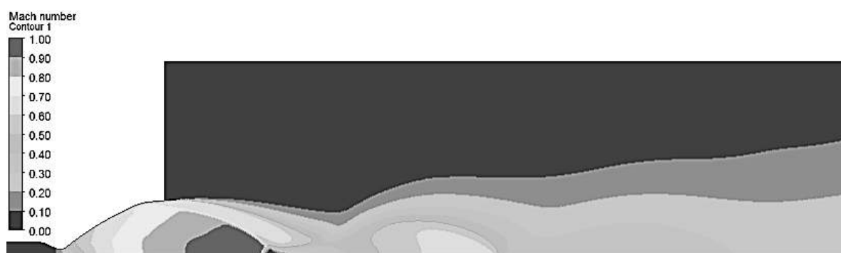
Рисунок 1 – Поле чисел Маха в профилированном сопле с коническим насадком
