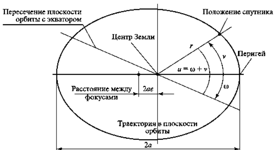
Рис. 2. Элементы Кеплера в плоскости орбиты [2]
