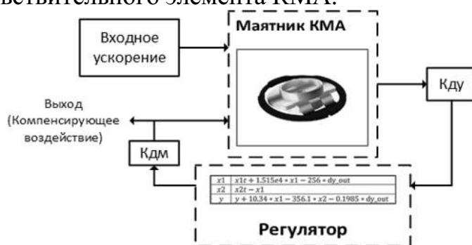
Рис. 3. Структурная схема модели чувствительного элемента маятникового акселерометра с замкнутым контуром обратной связи
