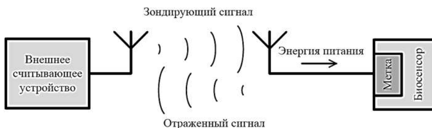
Рисунок 1 – Структура биосенсорной системы на базе технологии РЧИД с пассивными метками
