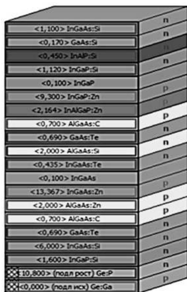
Рисунок 2 – Визуализация структуры каскадного ФЭП в ПО RCPAnalysis
