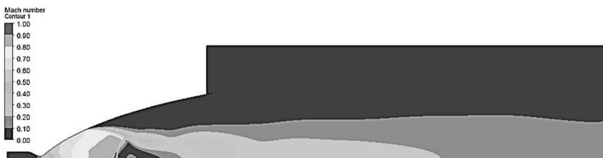
Рисунок 1 – Поле чисел Маха в профилированном сопле при земных испытаниях
