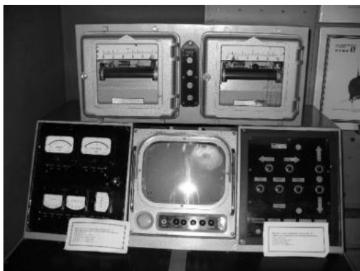
Рис. 4. Пульт управления «Луноходом-1»
