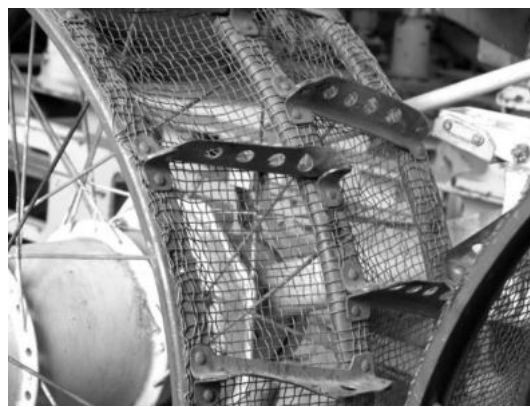
Рис. 3. Грунтозацепы колеса «Лунохода-1»
