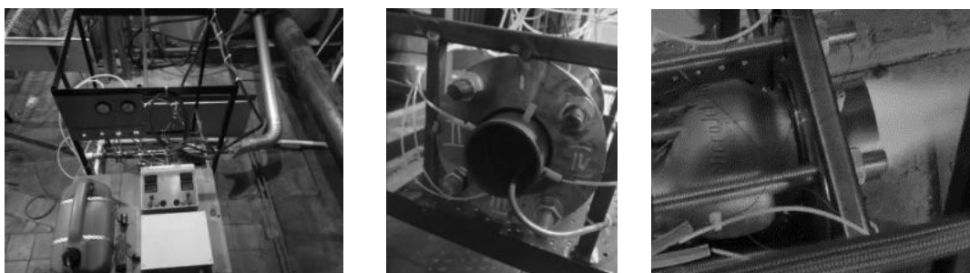
Рисунок 2 (а-в). Стенд для автономных испытаний КС с испарительными форсунками. а-общий вид стенда, б – средства измерения на выходе с камеры сгорания, в – стенд в работе
