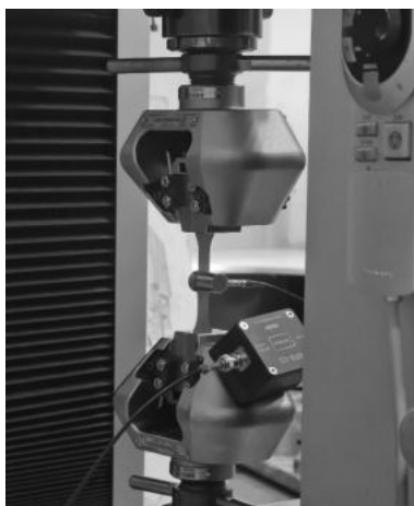
Рисунок 8 – Испытание образца на растяжение с акустической эмиссии
