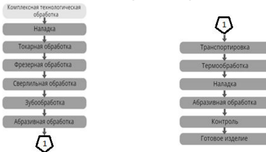
Рис. 3. Технологическая схема обработки зубчатых колес с использованием станков с ЧПУ
