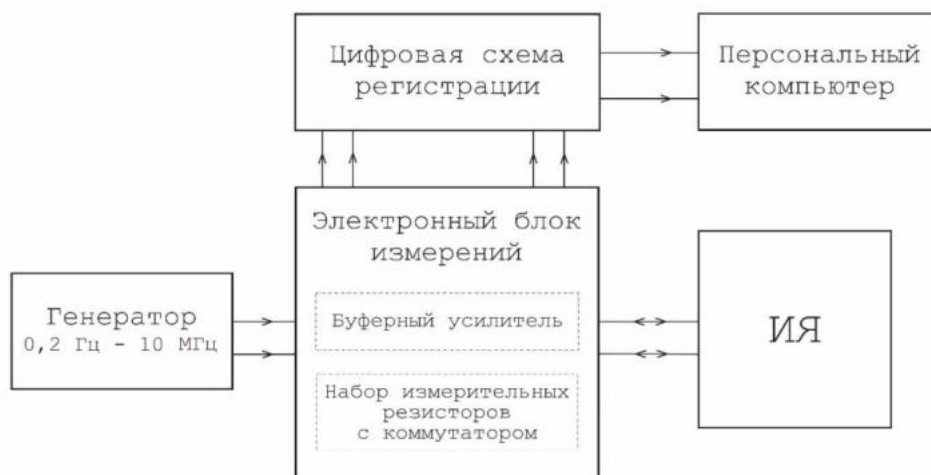
Рис. 3. Структурная схема экспериментального измерительного стенда
