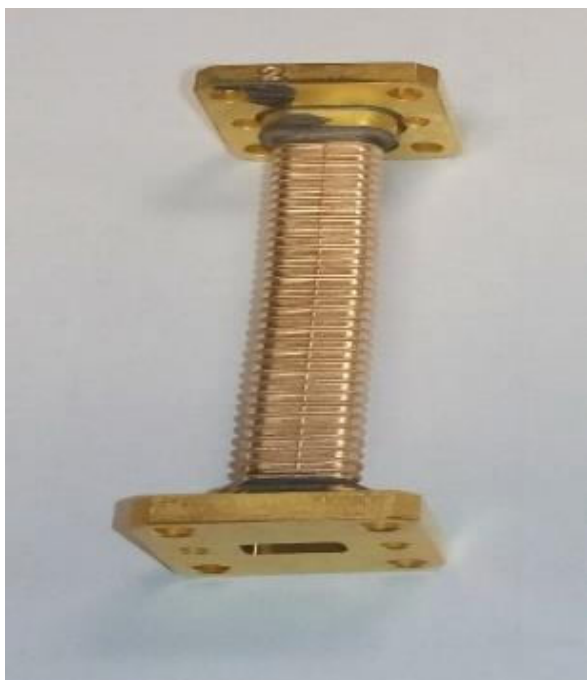
Фотография №3. Внешний вид гибкой волноводной секции, полученной из сварной заготовки ГВС
