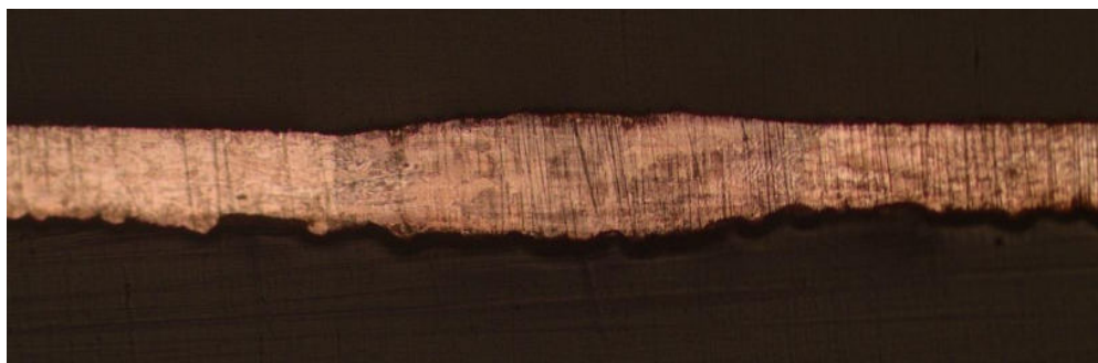
Фотография 2. Поперечное сечение № 2 сварного шва , ×200.
