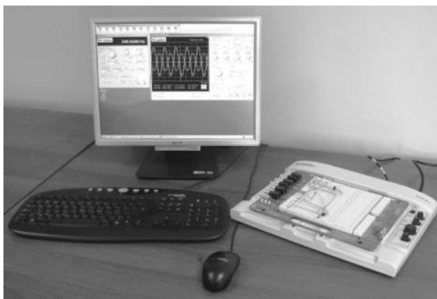
Рис 7. Аппаратная часть комплекса NI Elvis II
