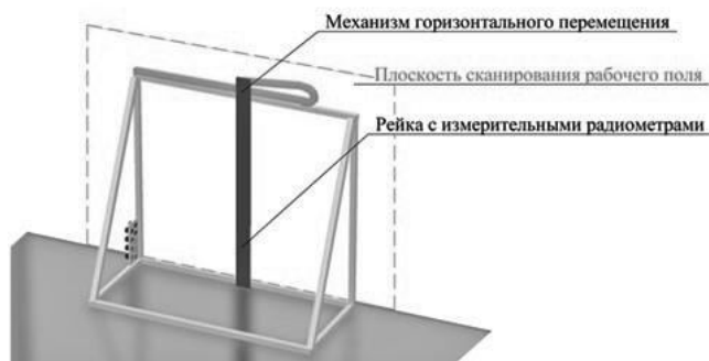
Рис. 2. Устройство сканирования рабочего поля с горизонтальным перемещением измерительной рейки
