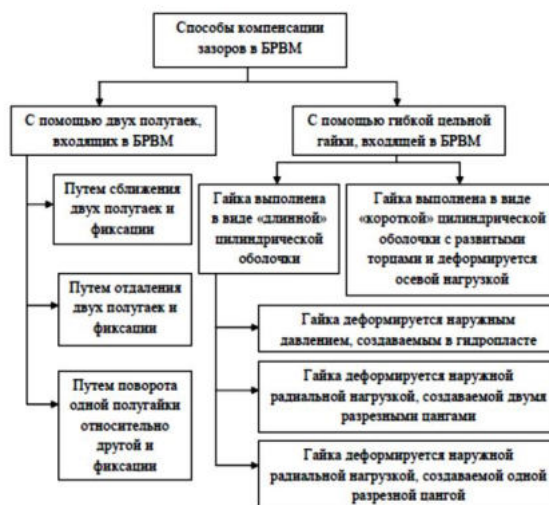
Рис. 2. Способы компенсации зазоров в безазорных ПРВМ
