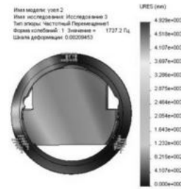
Рисунок 35 - Эпюра, полученная в результате частотного анализа, при варианте крепления №2
