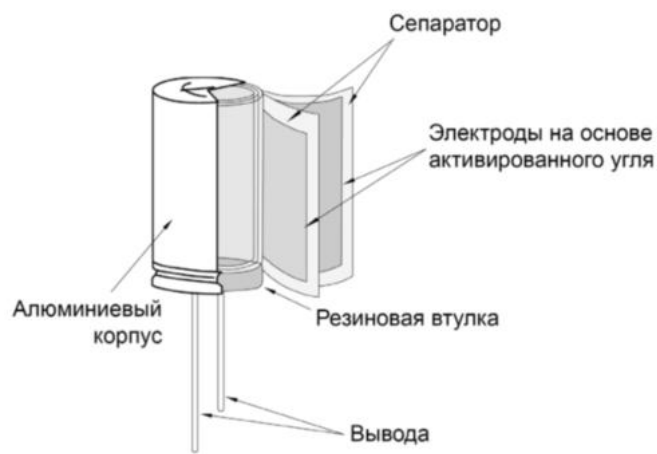
Рис.1. Устройство ионистора
