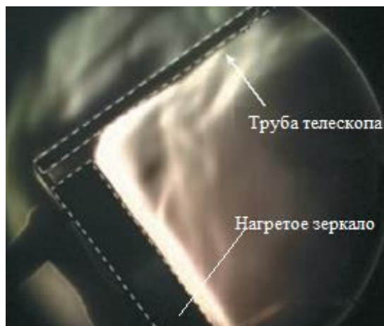
Рис. 4. Конвективное течение в трубе телескопа
