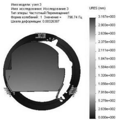
Рисунок 37 - Эпюра, полученная в результате частотного анализа, при варианте крепления №3
