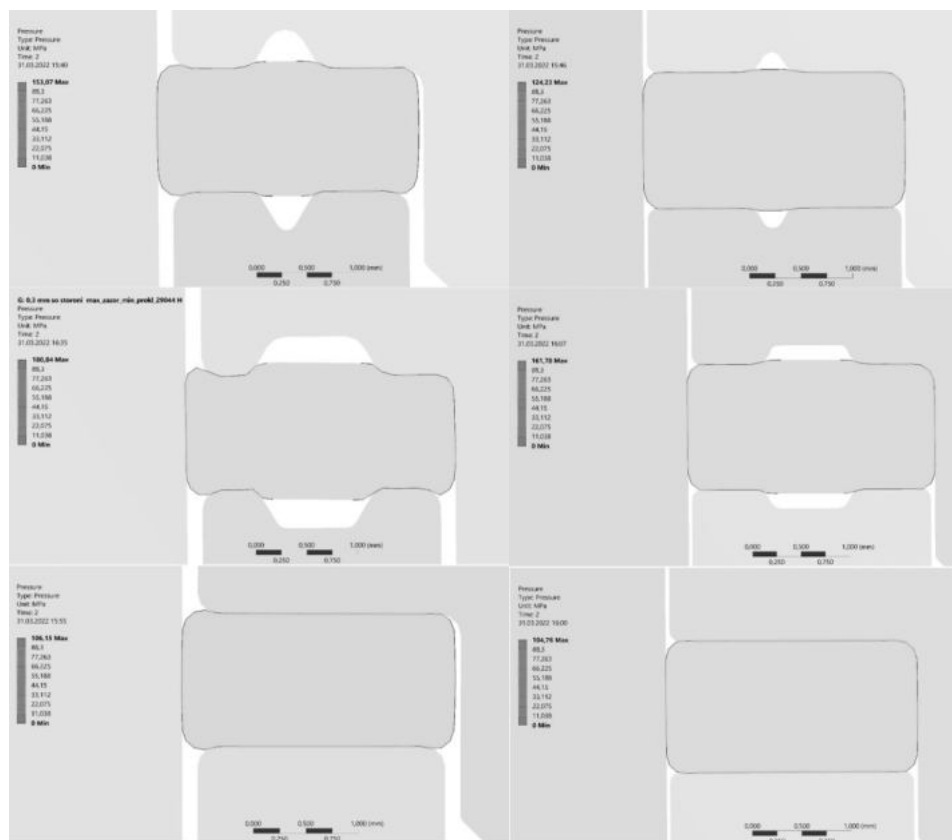
Рисунок 5 – Распределение контактного давления для вариантов с максимальными и минимальными радиальными зазорами затвора
