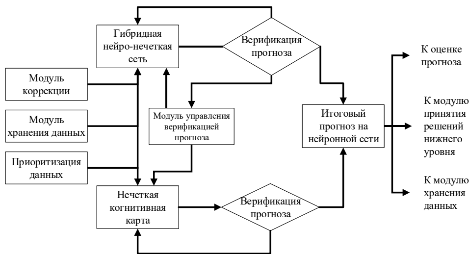
Рис. 1. Структурная схема модулярной системы с управлением достоверности верификации прогнозирования временных рядов
