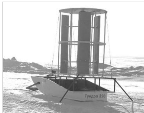
Рис. 3. Ветряная электростанция мощностью 300 Вт
