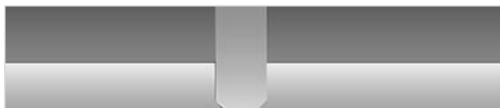
Рис. 1. Крепление элементов конструкции штифтом из КМ
