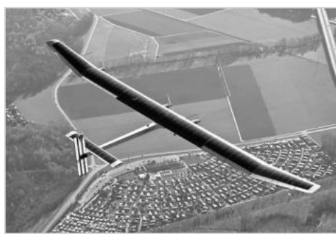
Рис. 4. Швейцарский электрический самолет на солнечных батареях Solar Impulse в полете. Черные прямоугольники на крыльях и стабилизаторе – солнечные батареи
