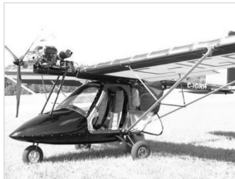
Рис. 7. Flightstar – ультралегкий американский одномоторный самолет, разработанный авиастроительной компанией Flightstar Sportplanes в 1987 году. Серийно выпускался на протяжении 22 лет с 1987 г. по 2009 г. в 8 вариантах, среди которых был, как показано на фотографии, и 2-х местный самолет. В зависимости от модификации максимальная скорость могла достигать 156 км/ч, максимальная дальность полета – 560 км
