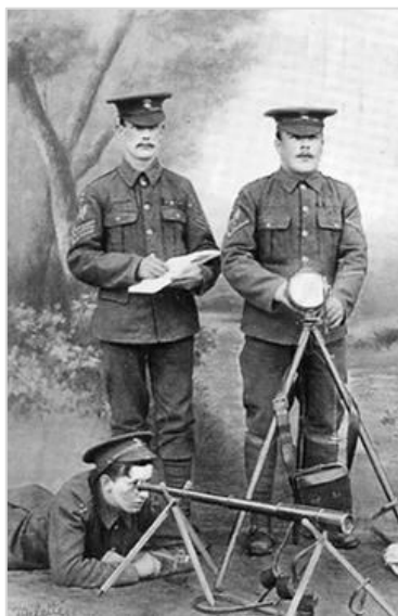
Рис. 22. Расчет гелиографа осуществляет двухстороннюю связь. Гелиограф устройство для передачи информации на расстояние посредством световых вспышек. Главной его частью является закрепленное в рамке зеркало, наклонами которого производится сигнализация серией вспышек солнечного или лунного света. Были широко распространены в армиях многих стран в XIX и начале XX века, в армии Великобритании и Австралии – вплоть до 1960-х, в армии Пакистана – до 1975г. Дальность связи в хороших условиях могла превышать 50 км. Рекорд дальности был поставлен в США в 1894 году и составил 295 км
