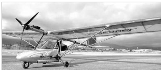
Рис. 6. Китайский электрический самолет eSpider, размах крыльев 10 м. Электродвигатель собственной разработки Yuneec Power Drive 24, мощностью 24 кВт с 3-х лопастным воздушным винтом находятся прямо над кабиной. Вес пустого самолета вместе с аккумулятором составляет 182,5 кг, максимальный взлетный вес – 282 кг. ЛА может совершать перелеты длительностью 1,5 часа с резервом в 30 мин. Для полной зарядки аккумуляторов требуется 3 ч. Максимальная скорость ЛА – 100 км/ч. Шум двигателя составляет всего 52 Дб. Он работает так тихо, что с высоты 0,3 км можно слышать, все, что происходит на земле
