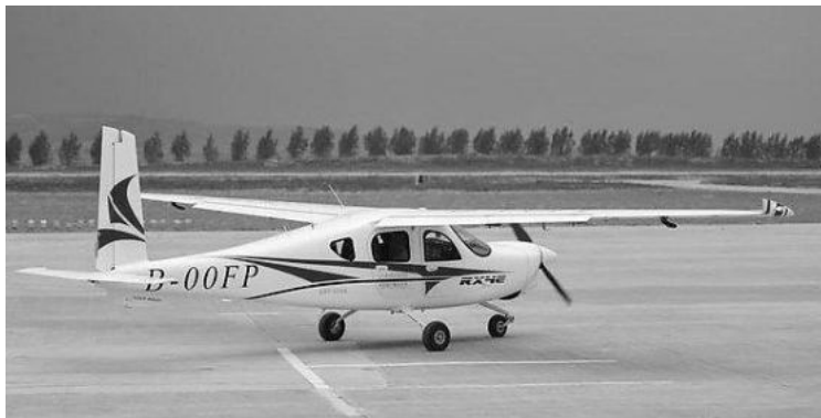
Рис. 13. Четырехместный электрический самолет RX4E. Длина – 8,4 м. размах крыльев – 13,5 м, масса – 1200 кг. В конструкции самолета широко используются углепластики
