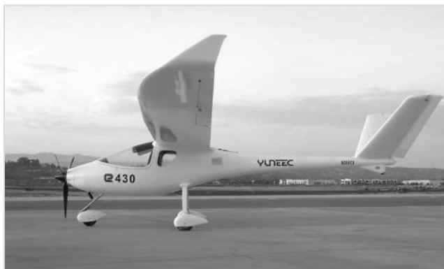
Рис. 8. Китайский электрический самолет Yuneec International E430 оснащен электрическим двигателем собственной разработки Yuneec Power Drive 40 мощностью 54 л.с., который питается от литиево-полимерных аккумуляторов. Размах крыла составляет 13,8м, длина – 6,98м. Масса ЛА с батареей стандартной емкости – 250кг, максимальная взлетная масса – 470кг, крейсерская скорость – 90км/ч, максимальная скорость – 150 км/ч, максимальная дальность полета – 225 км.
