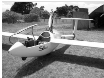
Рис. 2. Одноместный планер Alisport Silent Club. Обратите внимание – колонка с воздушным винтом выпущена из отсека, в котором она находится во время планирующего полета. Воздушный винт показан в сложенном состоянии
