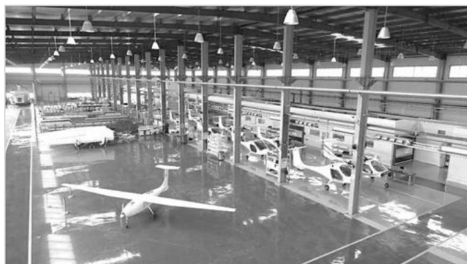
Рис. 11. Сборочный цех фирмы Liaoning Ruixiang General Aircraft Manufacturing Co., Ltd. На переднем плане видны БЛА, которые являются основной продукцией предприятия, справа, за рядом колонн – участок сборки электрических самолетов RX1E
