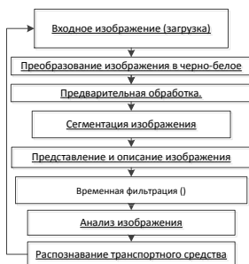
Рисунок 5 – Алгоритм распознавания автомобилей с помощью видеокамеры
