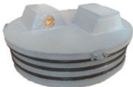
Крышка батарейного отсека, выполненная на 3D-принтере, с уплотнительными кольцами
