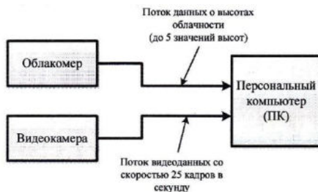
Рисунок 3 - Схема метода комбинирования измерений
