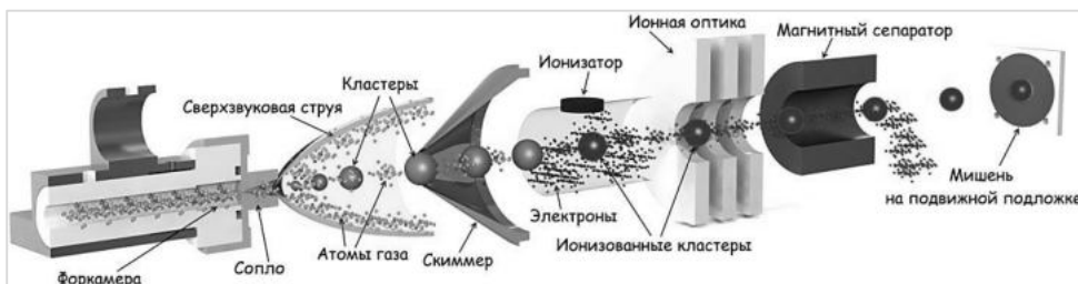
Рис. 1. Принципиальная схема формирования газоструйного ионно-кластерного пучка
