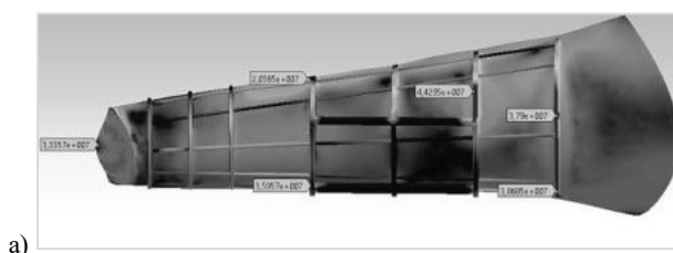
Рис. 2. Результат расчета нагрузки на отвале при угле атаки в 30 градусов для плотности 100 кг/м 3
