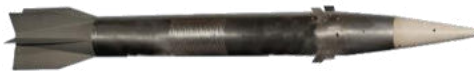
Рисунок 1 - 127-мм управляемый дальнобойный артиллерийский снаряд Vulcano GLR в полетной конфигурации (с) Oto Melara (via Jane's). Подкалиберный, с поддоном
