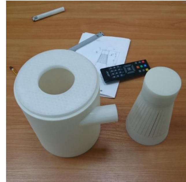
Рис.3.Элементы конструкции изготовленные методом FDM
