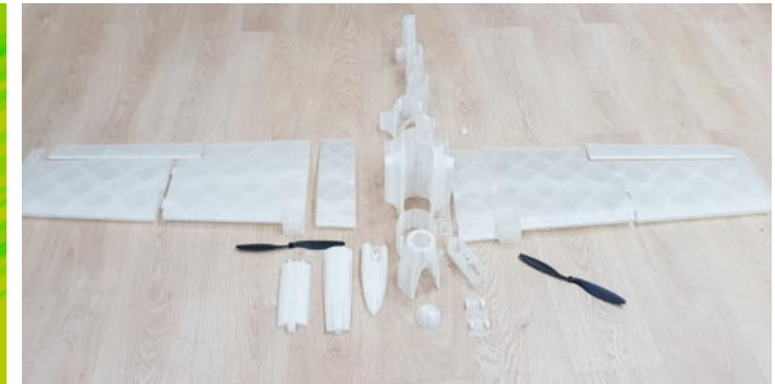
Рис.3.Элементы конструкции изготовленные методом FDM
