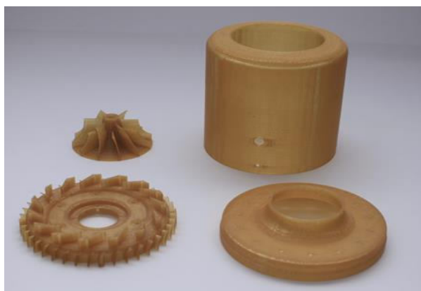
рис.3 элементы изготовленные методом FDM
