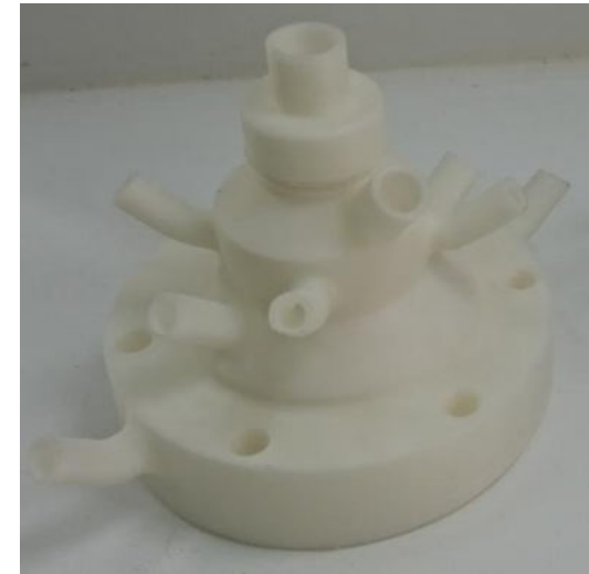
Рис.3.Элементы конструкции изготовленные методом FDM
