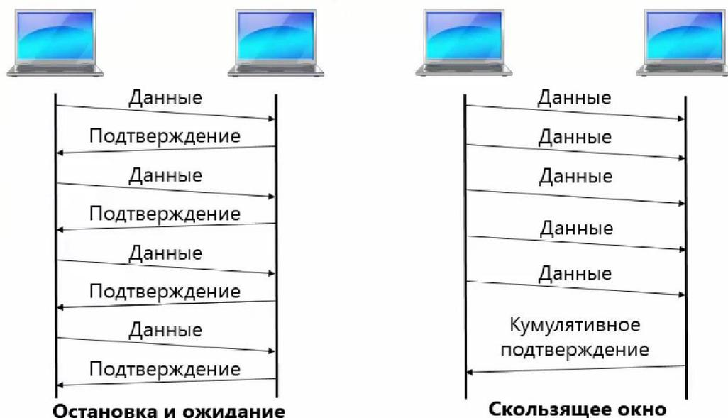
Рис 2: Диаграммы передачи пакетов при использовании различных методов подтверждения передачи.
