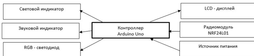
Рисунок 12 – Структура принимающего блока
