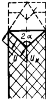
Рисунок 18. Разрушение поверхности в области теплопроводной проволоки, где: \alpha – угол полураствора конуса; U – нормальная скорость деградации вещества; U_m – скорость вдоль нити
