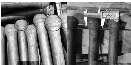
Рисунок 1 – Варианты брака после операции высадки
