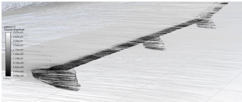
Рисунок 3 – Картина линий тока набегающего потока
