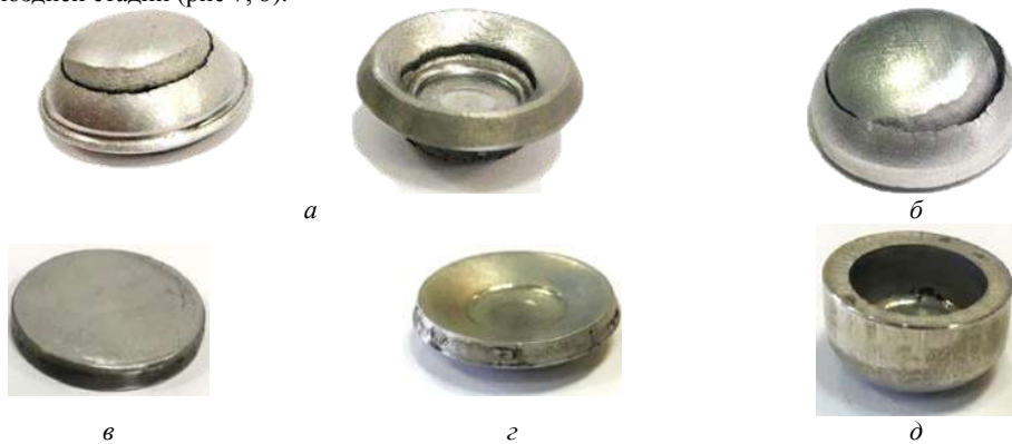
Рис. 7. Экспериментальные образцы после разрушения (а, б), исходная заготовка (в), полуфабрикат после подштамповки (г) и после свертки (д)
