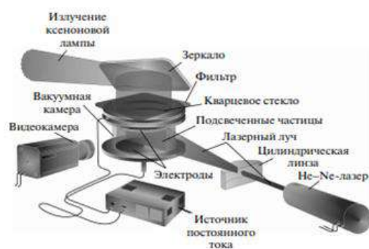
Рис. 2. Схема наземного эксперимента по изучению пылевой плазмы
