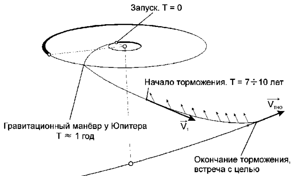
Рисунок 1. Схема перелёта АМС.
