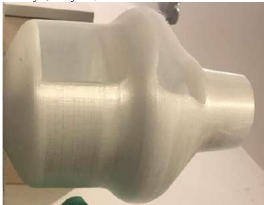
Рис. 5. Мастер модель надульного устройства, изготовленная из выплавляемого материала
