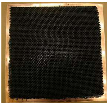
Рис. 4. Окрашенный черной эмалью сотозаполнитель.
