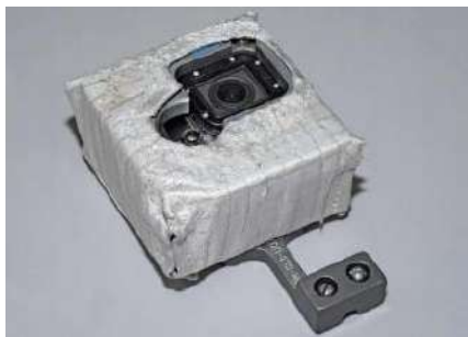
Рис. 3. Автономный видео комплекс космонавта (для использования в условиях открытого космоса на Международной космической станции видеокамера GoPro обёрнута в ЭВТИ)
