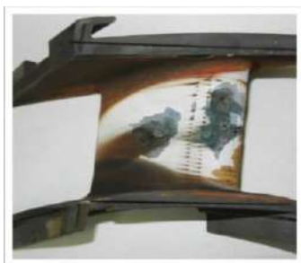
Рис. 1. Прогары сопловых лопаток после испытаний [1]
