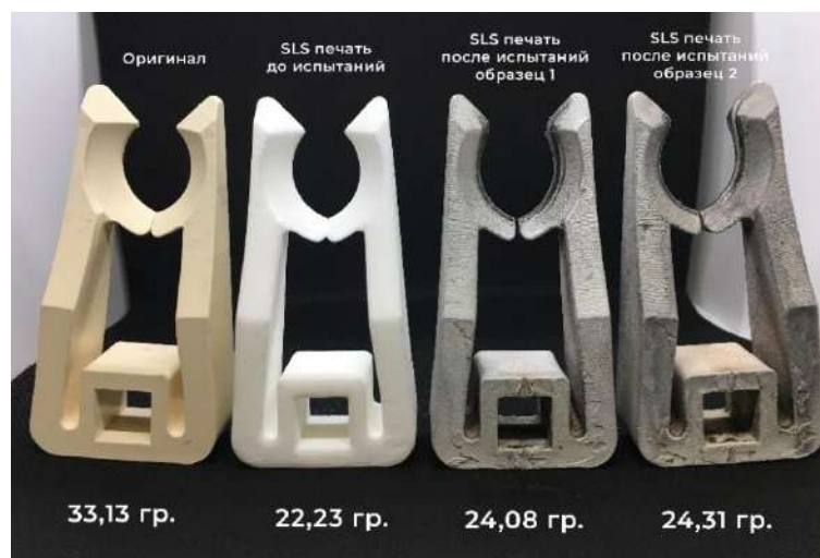
Рисунок 6. Изменение массы фиксатора до и после испытаний
