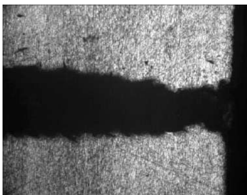
Рис. 5. Выходное отверстие, жаропрочный сплав, толщина 3 мм
