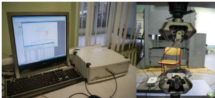
Рис. 3. Прибор акустической эмиссии, образец в захватах в процессе испытаний проволоки БрНХК
