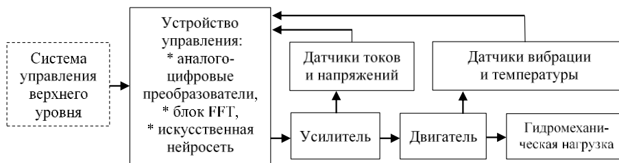
Рисунок 2 – Функциональная схема системы диагностики и управления двигателем
