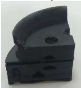
Рис. 12. Разрез модели с адаптированными каналами
