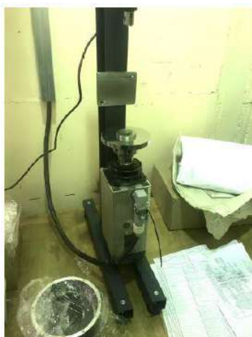
Рисунок 5 – Стенд для проведения экспериментальных исследований упорных ГП роторов ТГ, ВСУ и СУ в процессе сборки
