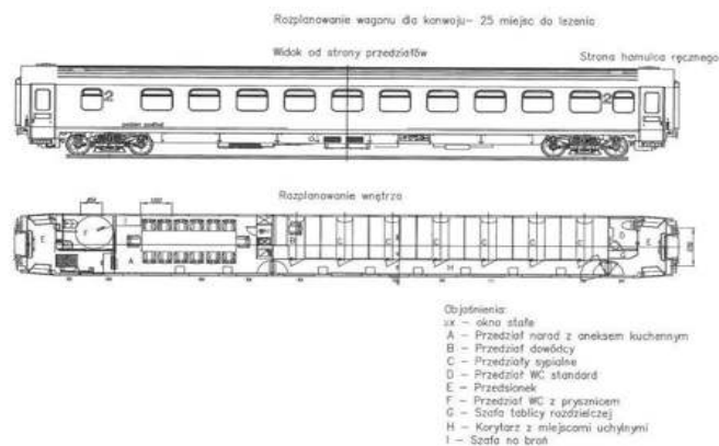
Рис. 5 Схема вагона с местами для лежания для перевозки караула
