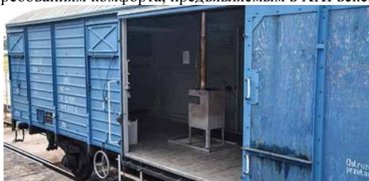
Рис. 3 – Крытый вагон типа xKL для перевозки солдат
