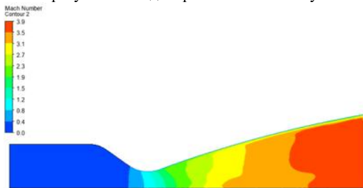
Рис. 6. Распределение числа маха по проточной камере
