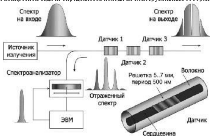
Рис. 5. Принцип действия измерительной системы на основе сенсоров Брэгга
