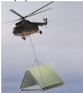
Рис. 1. Транспортировка площадки на вертолетной подвеске.
