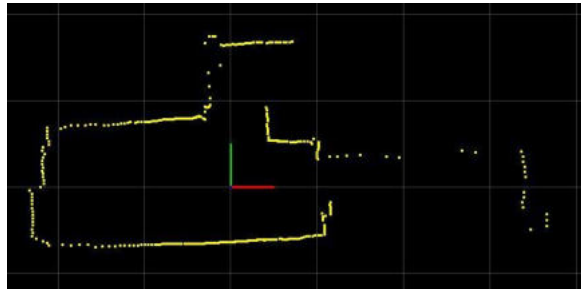
Рис. 1. Пример 2D карты помещения, построенной системой LIDAR.
