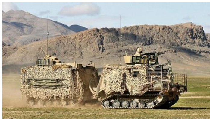
Рис. 3. Двухзвенный гусеничный транспортер BV S 10
