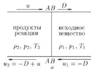
Рис. 5. Упрощённая модель детонационной волны Уравнения динамической совместности на поверхности сильного разрыва:
