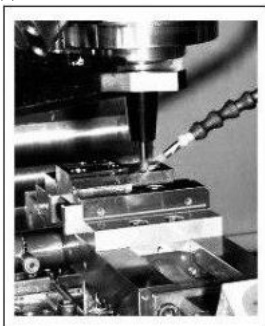
Рис. 3. Обеспечение малого расхода смазки с внешним подводом.
