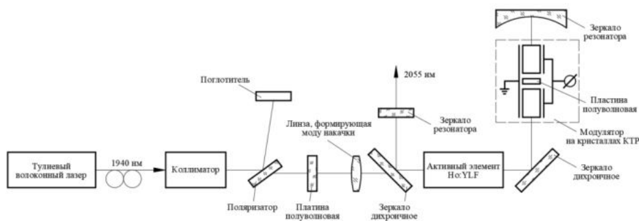
Рис. 3. Оптическая схема Ho:YLF лазера с модулятором на кристаллах КТР
