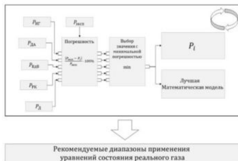
Рис. 4. Схема определения рекомендуемых диапазонов применения уравнений состояния реального газа
