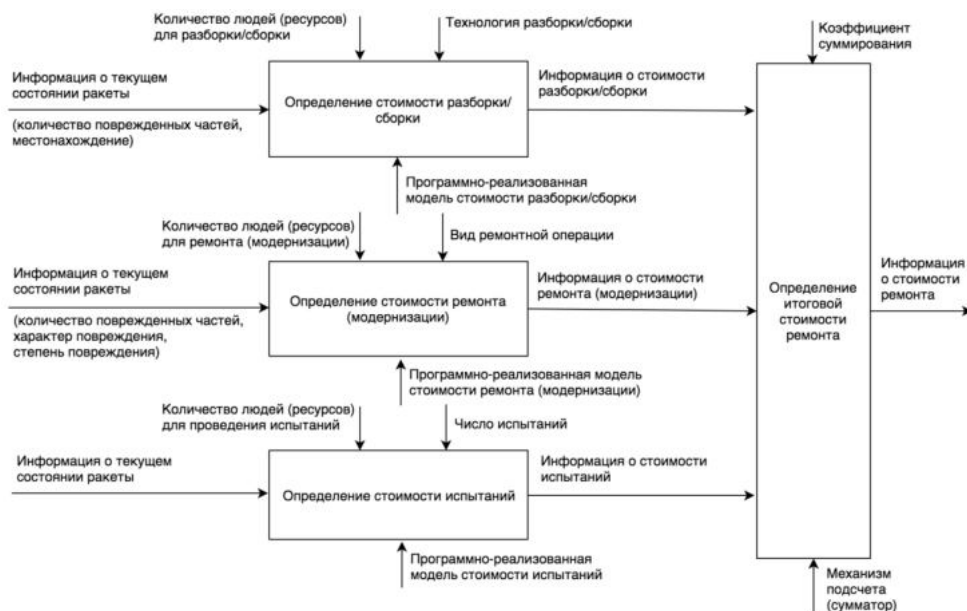
Рис. 2. Функциональная модель выстраивания логики оценивания стоимости ремонта.
