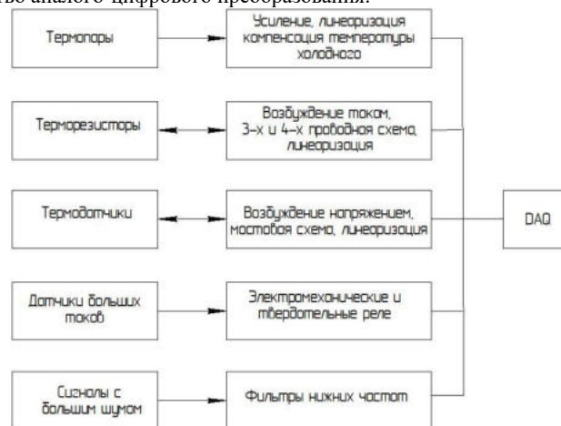
Рис. 6. Типы датчиков и сигналов и виды преобразования
