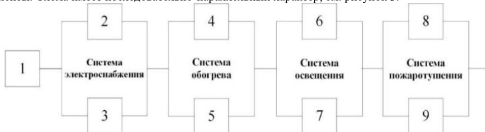
Рис. 3. Структурная схема соединения основных элементов силового блока кухни арктической КА-250/30ПМ по надёжности: 1 – цельнометаллический термоизолированный обогреваемый кузов; 2 – дизель электростанция мощностью 100 кВт; 3 – резервная ДЭС мощностью 5 кВт; 4 – отопительно-вентиляционная установка; 5 – резервная система обогрева; 6 – основная система освещения; 7 – аварийная система освещения; 8 – автоматизированная система пожаротушения; 9 – резервные огнетушители.
