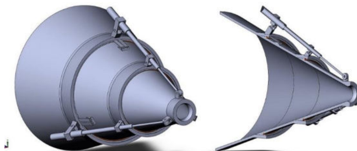
Рис. 7. Облегченная конструкция в разложенном состоянии
