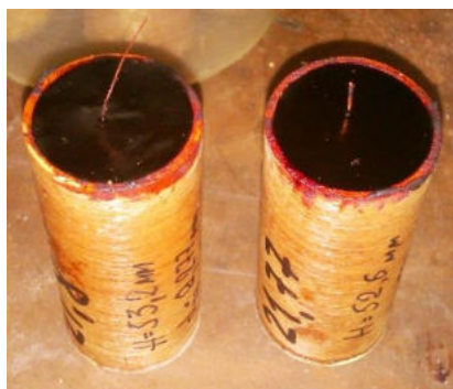
Рис. 6. Капсулы с медной струной по оси заряда.
