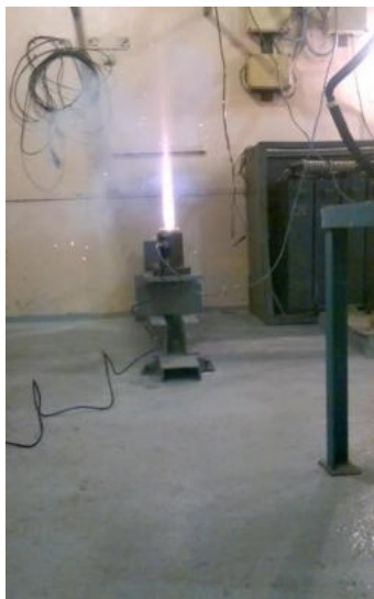
Рис. 1. лабораторный модельный ракетный двигатель, диаметр 30 мм.
