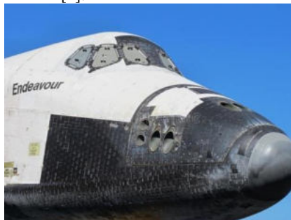
Рис. 4. плиточная пассивная тепловая защита шаттла Индевор
