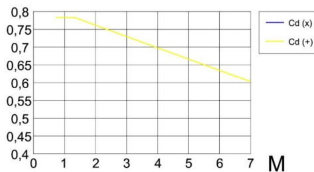
Рис. 5 Результаты расчета коэффициента центра давления C_d при расположении стабилизаторов (+) и (x)
