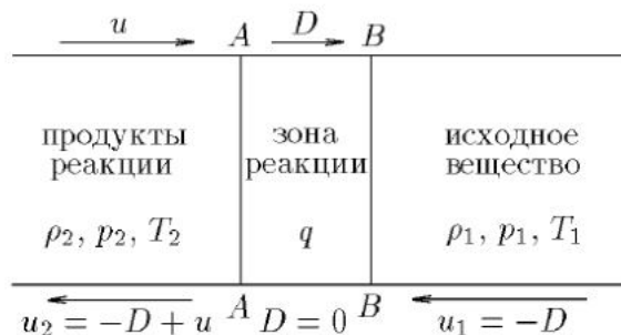
Рис. 4. Модель детонационной волны (Рисунок взят из [6])
