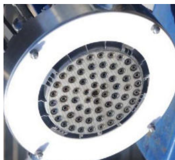
Рис. 4. Форсуночная головка, распечатанная на 3D принтере.
