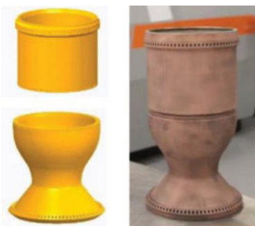
Рис. 3. Корпус КС и сопла, изготовленные из медного сплава аддитивным способом.
