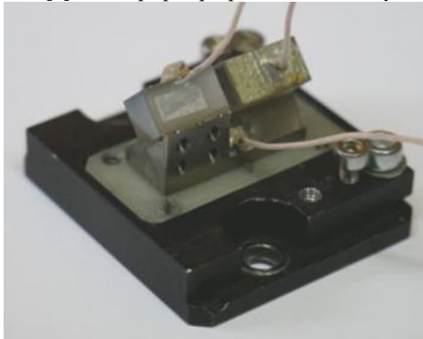
Рис. 1. Сборка с разворотом осей кристаллов
