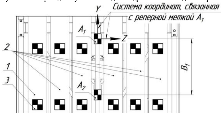
1 – ТПК ИРС; 2 – ГММ; 3 – реперная метка; A1, A2 – условное обозначение (номер) реперных меток; B1 – база между реперными метками
