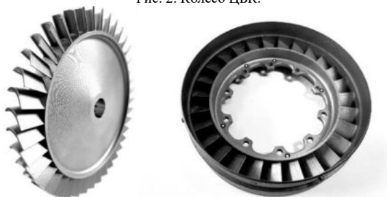
Рис. 3. РК (слева) и СА осевой турбины (справа).
