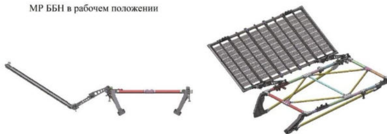
Рис. 5. Схема приведения ББН в рабочее положение
