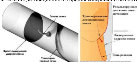
Рис. 1. Структура спиновой детонации в трубе. (Рисунок взят из [4])
