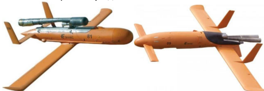
Рис. 1. Отечественные БПЛА с одним ПуВРД (слева) и с двумя ПуВРД (справа) U – образного типа
