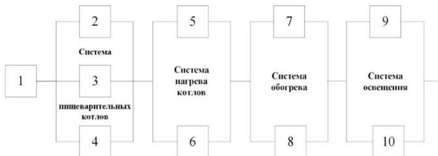
Рисунок 4 - Структурная схема соединения основных элементов технологического блока кухни арктической КА-250/30ПМ по надёжности: 1 – цельнометаллический термоизолированный обогреваемый кузов; 2,3,4 – три котла пищеварочных на электрическом и паровом обогреве вместимостью по 160 л для приготовления первого, второго и третьего блюд; 5 – электрическая система нагрева пищеварочных котлов; 6 – парогенератор (резервная система нагрева пищеварочных котлов); 7 – отопительно-вентиляционная установка; 8 – резервная система обогрева; 9 – основная система освещения; 10 – аварийная система освещения (резервная).
