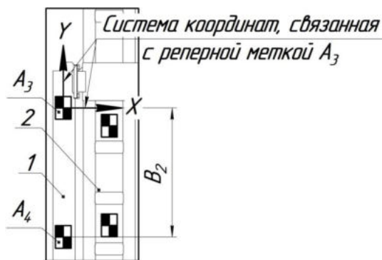
1 – КЧ; 2 – ИРС; A3, A4 – условное обозначение (номер) реперных меток; B2 – база между реперными метками
