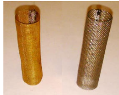
Рис. 4. ТПЭ из латунной и металлической сетки.
