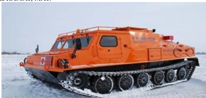
Рис. 2. Гусеничный вездеход-топливозаправщик ГТ-ТР-04 “СКИФ”
