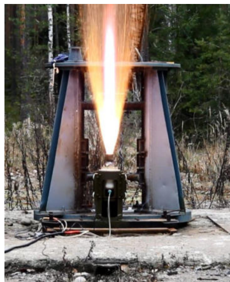
Рис. 2. Полигонный модельный ракетный двигатель, диаметр 100 мм.
