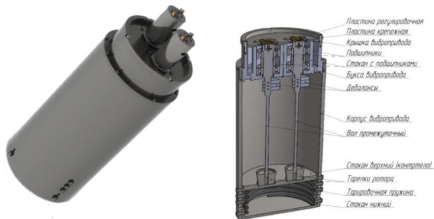
Рис.2. Новая конструкция вибропривода для динамических испытаний узлов летательных аппаратов
