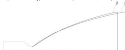
Рис. 1. Изменение формы сопла по сравнению с базовым вариантом: 1 - базовый профиль, 2 – профиль, полученный в результате оптимизации
