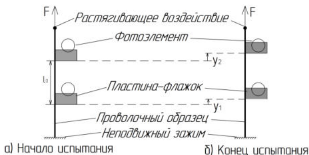
Рисунок 1 – Принципиальная схема измерения деформации проволоки оптоэлектронным методом
