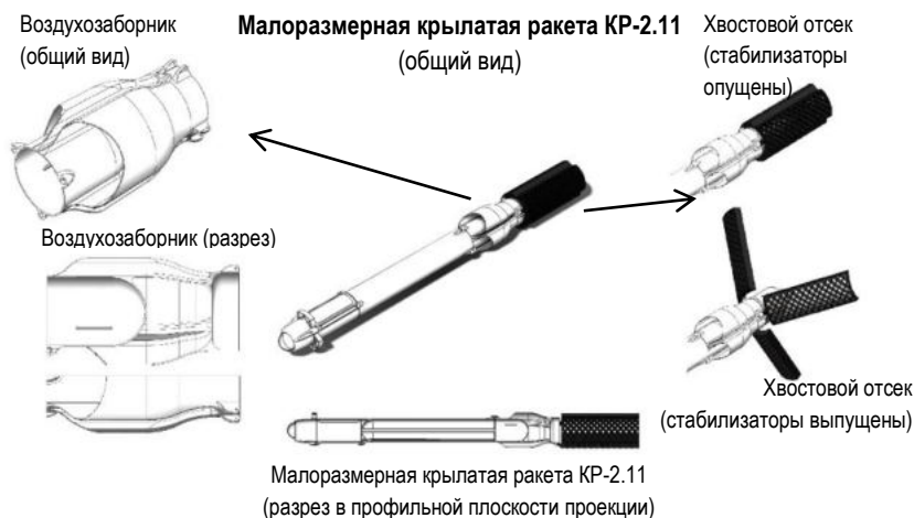
Рисунок 1. Один из прорабатываемых вариантов ракеты на примере модели КР-2.11.
