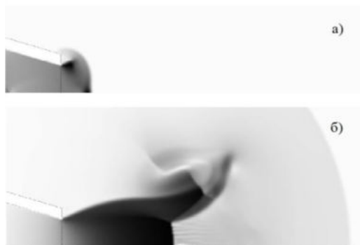
Рисунок 1 Картина развития течения в импульсной струе, а - начало истечения, б - формирование вихревой структуры.
